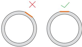
2. Pousser l'Outil de démontage avec précaution dans l'espace entourant l'appareil. Si nécessaire, faites pivoter doucement l'outil de gauche à droite.
