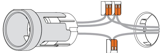
5. Une fois les réparations terminées, réintroduisez soigneusement les connecteurs et les conducteurs à l'intérieur de la boîte électrique. Ensuite, réinsérez l'appareil dans l'ouverture et assurez-vous que les quatre languettes de verrouillage sont enclenchées.
