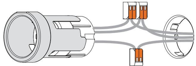
5. Una vez terminadas las reparaciones, vuelva a introducir con cuidado los conectores y conductores en el interior de la caja eléctrica. A continuación, vuelva a introducir el dispositivo en la abertura y asegúrese de que las cuatro lengüetas de bloqueo queden encajadas.
