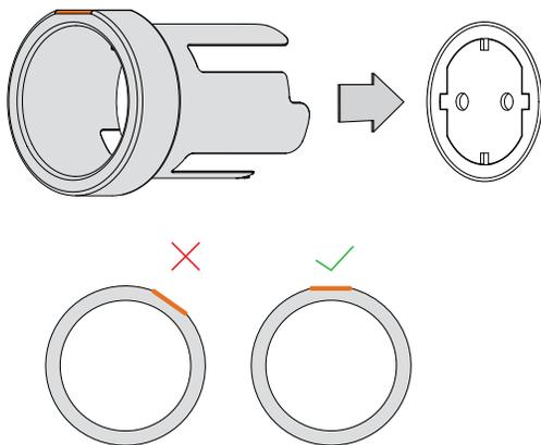
2. Empuje la herramienta de extracción con cuidado en la ranura que rodea el dispositivo. Si es necesario, gire suavemente la herramienta a izquierda y derecha.
