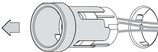
4. Ziehen Sie die Stecker und Leiter vorsichtig aus dem Inneren des Elektrokastens und führen Sie die erforderlichen Reparaturen durch. Da die Anschlüsse je nach Gerät unterschiedlich sein können, finden Sie weitere Einzelheiten in den jeweiligen technischen Datenblättern.
