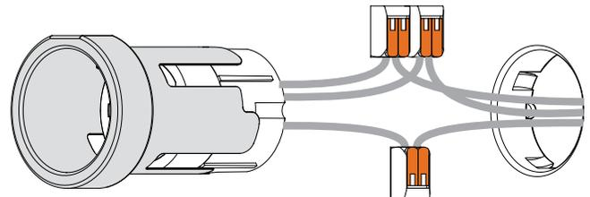
5. Wenn die Reparaturen abgeschlossen sind, setzen Sie die Stecker und Leiter vorsichtig wieder in das Innere des Elektrokastens ein. Setzen Sie das Gerät dann wieder in die Öffnung ein und vergewissern Sie sich, dass alle vier Verriegelungslaschen eingerastet sind.
